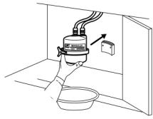
**注意** カートリッジ取付け後は3分間以上浄化水を流してください。(不安定な吸着剤が混入しており飲料不可ですので必ず放流してください。)
