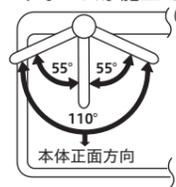
施工例2 (正面の角度を内側へずらした例)
