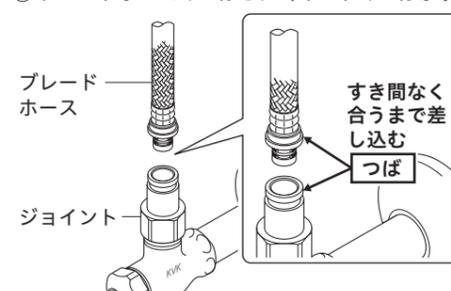
【ブレードホースの曲がりがつき場合】接続銅管部をゆるやかに曲げて、ブレードホースの曲がり方を調整してください。
